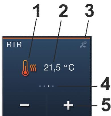
Abb. 8: Übersicht der Bedien- und Anzeigeelemente des Raumtemperaturreglers
