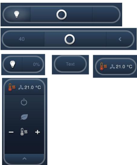
In der Regel erfolgt die Aktivierung (z. B. An-Aus) über das Drücken des Symbols. Hierdurch können aber auch weitere Funktionen, wie z. B. Regler geöffnet werden. Die „Blase“ öffnet sich entsprechend. Auch das Drücken von Pfeil-Schaltflächen zeigt zusätzliche Funktionen an.
