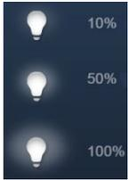
Voreinstellungen von Schritten oder Stufen (z. B. Dimmschritte, Lüfterstufen) werden in weißer / heller Schrift / Symbolik dargestellt. Die Schritt- oder Stufenwerte können vorgegeben werden. Im folgenden Beispiel wird der Helligkeitswert „20 %“ angezeigt. Es erfolgt eine 1 Byte-Rückmeldung.
